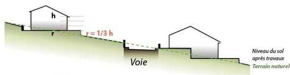
La construction est intégrée dans la pente, grâce à des terrassements sur plusieurs niveaux
