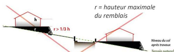
La construction est mal intégrée dans la pente.
